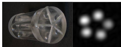
Photo d'une cellule (5 tubes de 5cm de long) et image du gaz He3 polarisé dont on la remplit.
