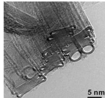
Imagerie électronique d'un fagot de nanotubes de carbone, où certains nanotubes présentent une déformation de leur structure [4]
